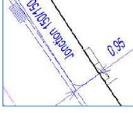
Les cotations sont utilisées pour repérer au sol la position des câbles en indiquant la distance entre les canalisations et des repères (mobilier urbain ou façades d'immeubles) visibles, fixes, et durables sur le terrain.
